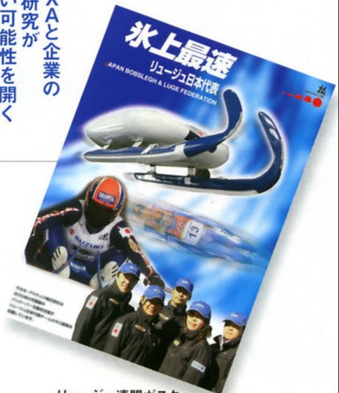
リュージュ連盟ポスター 宇宙航空分野で得られた技術を、氷上最速のスポーツ分野へ。新しい炭素繊維強化プラスチックは、リュージュのソリの胴体部分に採用される。
